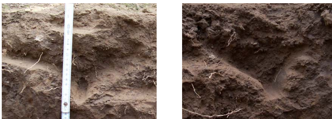
Figure 3. Détails du profil relatif à la parcelle « Décompactage de printemps + semis à plat » - Empreintes laissées par deux types de dents différents.
