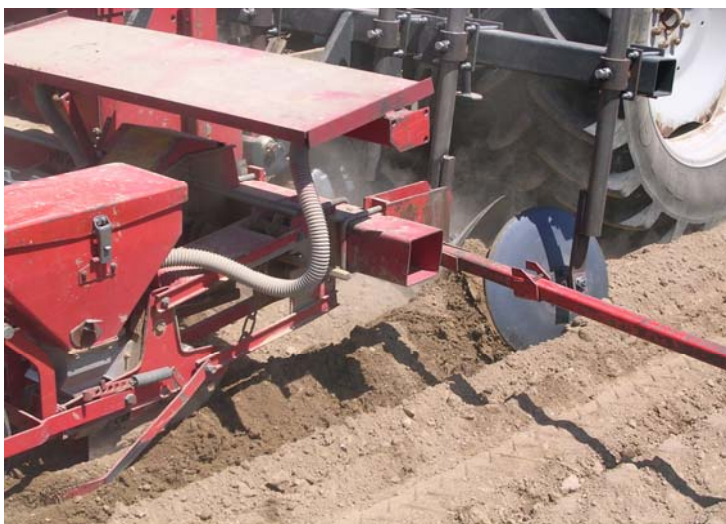
Semis sur buttes réalisées par un châssis équipé de disques concaves
