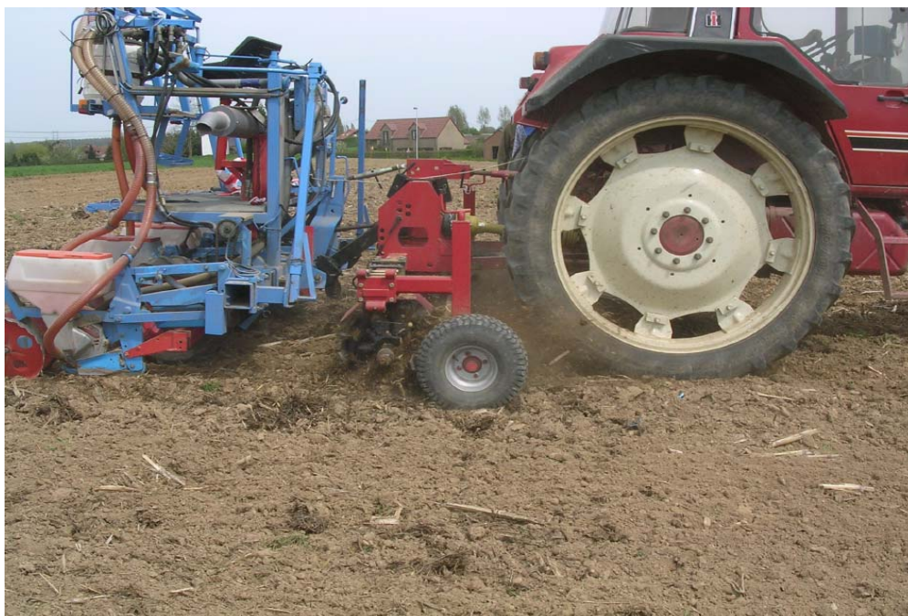
Photo1 : Attelage chass'débris + semoir Monosem maïs au travail à Buzet (B)
