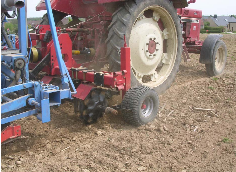
Photo2 : Chass'débris au travail dans les résidus de maïs
